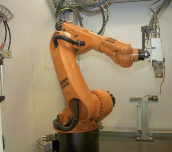
Einblick in das Innenleben der Laserschweißanlage, in der ein mannshoher Roboter seinen Dienst verrichtet
