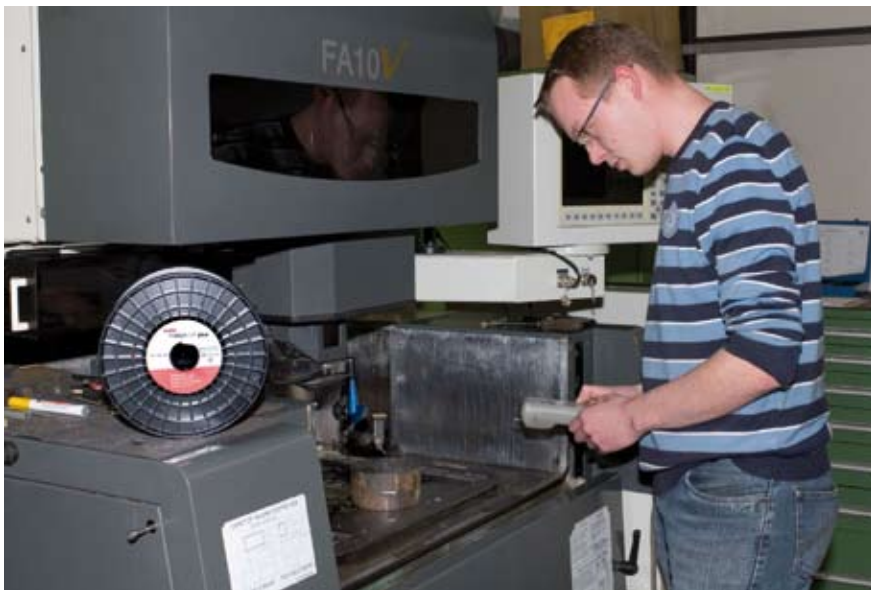
Bild 1: René Haag beim Einstellen der Mitsubishi FA10V-Drahterosiermaschine
