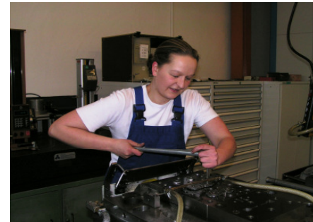
Katharina Busch bei der Überholung eines Feinschneid- werkzeugs im Betriebsmittelbau
