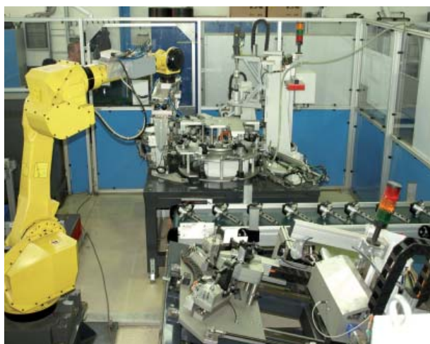
Der Roboter sorgt für automatisches Be- und Entladen der Messstationen im End-of-Line-Prüfstand.
