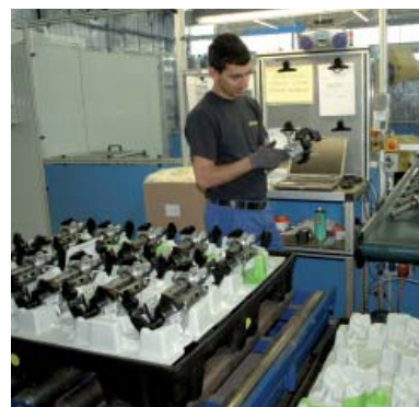
Serdal Tunc kontrolliert die fertigen Dome am End-of-Line-Prüfstand vor dem Verpacken.
